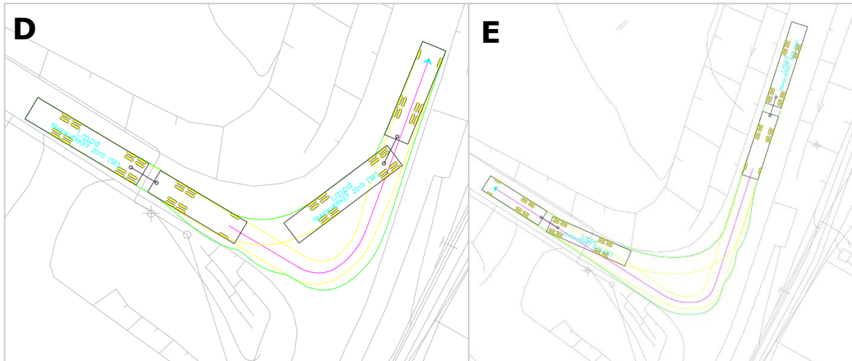
Figur 9. Körspårkontroller för lastbil med släp.
